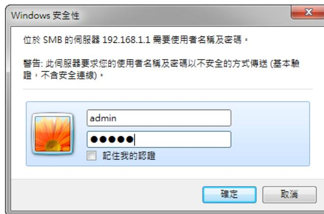
登入後在左側選單選取「無線網路」「AP 模式」，將右側的「AP 模式」切換成「獨立 AP 模式」，按下確定後設備將重新啟動成獨立 AP 模式。如果需要修改 AP 的 IP 位址，也可以在下方「網路連線設定」的地方一併修改。
